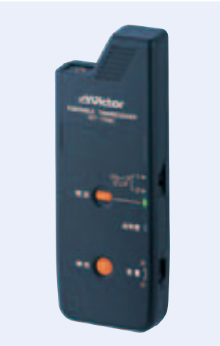
ポータブルトランシーバー WT-TR60 ●空中線電力:10mW●受信感度:0dB \mu 以下 (12 dB SINAD) ●電源:DC3.6 V (専用充電池) ●使用時間:約16時間 (満充電、10%使用率時) ●外形寸法:幅53 mm ×高さ142 mm ×厚さ21.5 mm●質量:0.15 kg (専用充電池含む)
