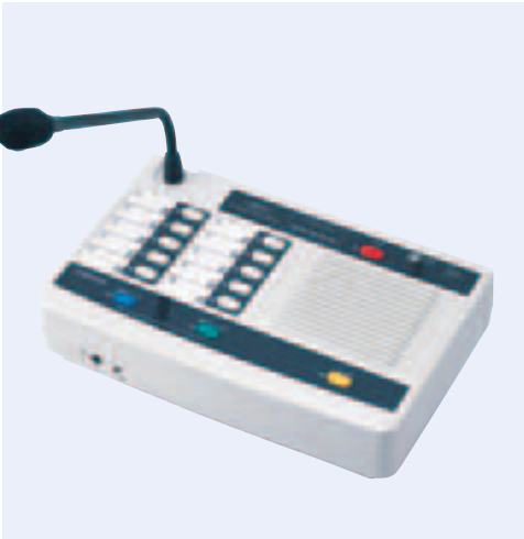
ホールマスター WT-MC80 ●電源:DC15V (WT-M60又はWT-M80より供給) ●外形寸法:幅250mm×高さ63mm×奥行160mm (フレキシブルマイクホン含まず) ●質量:2.1kg (フレキシブルマイクホン含む)
