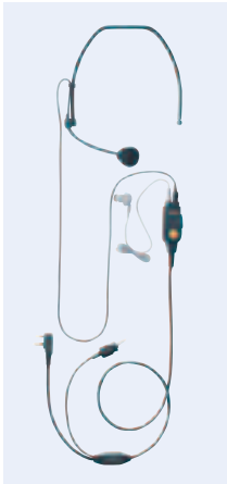
コントロールマイクホン WT-UM12 ●型式:エレクトレットコンデンサー型 ●ケーブル長:マイクコード0.7m、ツインプラグコード0.8m ●質量:100g (ケーブル含む)
