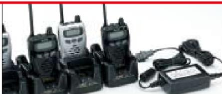
連結スタンドEDC-158R(単品販売x4個)とACアダプターEDC-162を連結し、1つのコンセントで最多8台の無線機を充電するチャージャーを作ったイメージです。EDC-162は最多4個のEDC-158Rを駆動でき、EBP-70単体でも無線機に装着した状態でも、また1~8台のうち任意の台数を充電できます。他にこのスタンド1個と小型アダプターをセットにした、EDC-158Aツイン急速充電器もございます。
