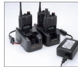
最多4台のEDC-167RとEDC-162ACアダプター1台を組み合わせ、8台同時に充電できるマルチチャージャーが作れます。
